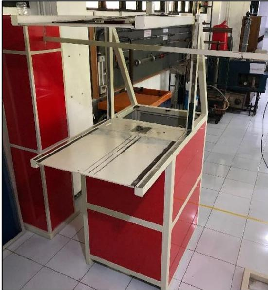
Gambar 3. 5 Penyangga Turbin Savonius
