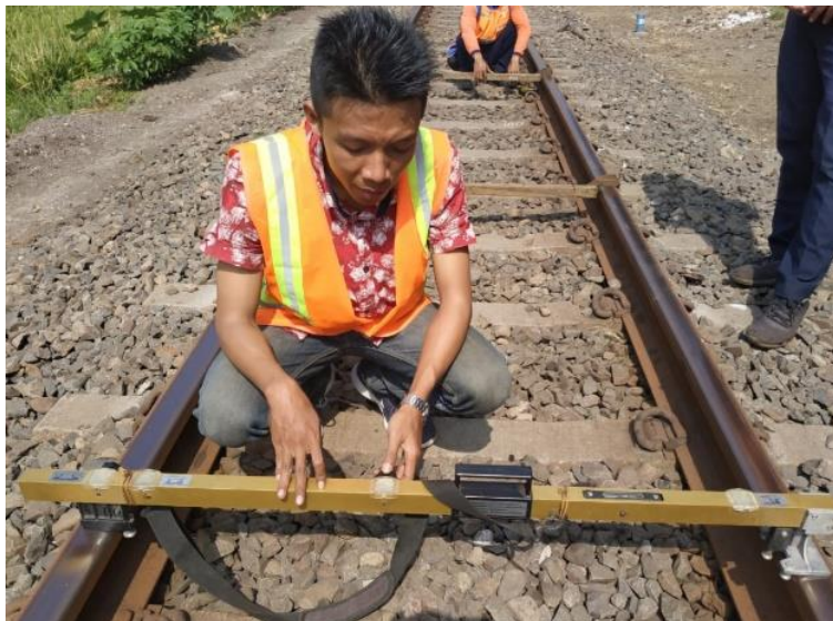
Gambar 3.4 Cara Kerja Alat Ukur Manual (Survey lokasi, diambil tanggal 29 Agustus 2019)
