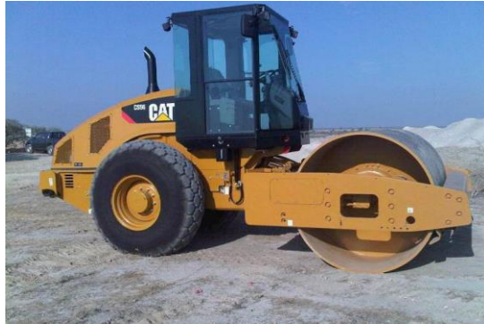
Sumber : Dokumentasi Penulis Gambar 2. 5 Vibratory Roller
