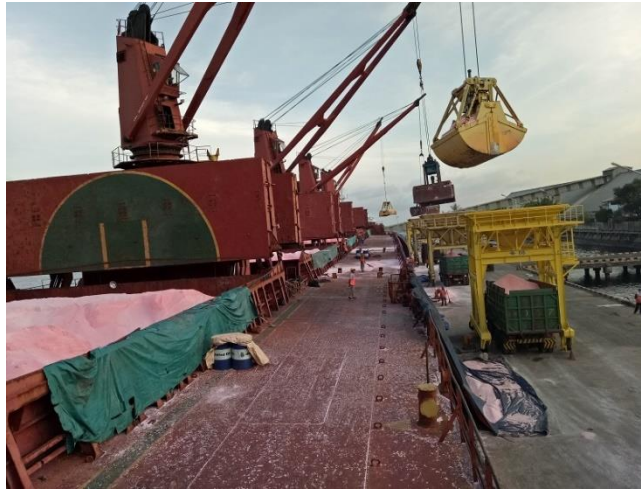
Gambar. 4. 10 Pemuatan Pupuk Curah ke Dalam Truk di Pengantongan Banyuwangi
