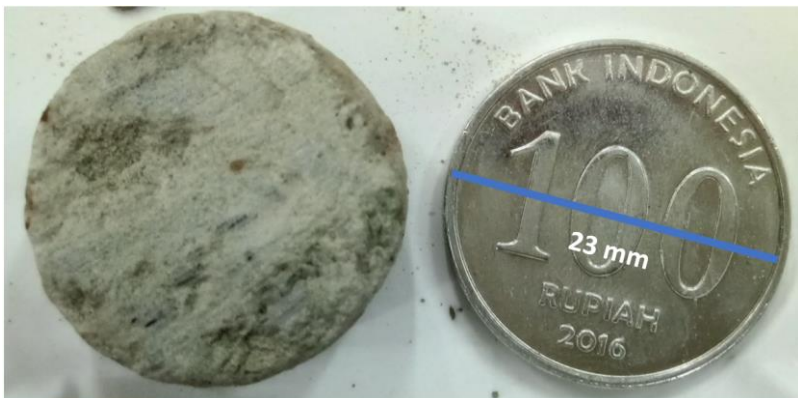
Gambar 3.2 Contoh Sidewall Core dari sumur
