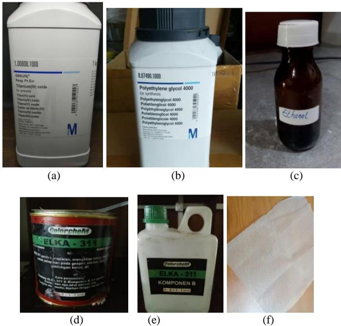
**Gambar 3.3** Alat dan Bahan pembuatan sampel fotokatalis : (a) TiO<sub>2</sub>, (b) PEG, (c) etanol, (d) resin, (e) hardener, (f) kain kasa nylon
