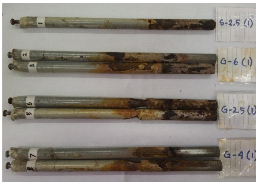
Gambar 4 - 72 Visualisasi tulangan karat setelah dilepas dari kubus
