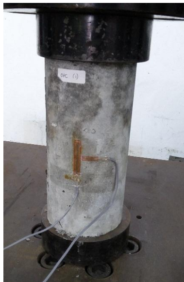
Gambar 4 - 8 Pengujian kuat tekan beton OPC umur 30 hari
