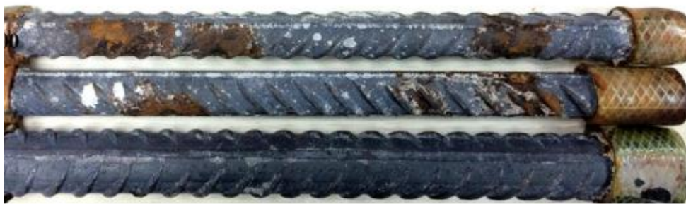
Gambar 2 - 3 Korosi tulangan baja setelah 1 tahun pemaparan di splash zone (Liu et al., 2016)
