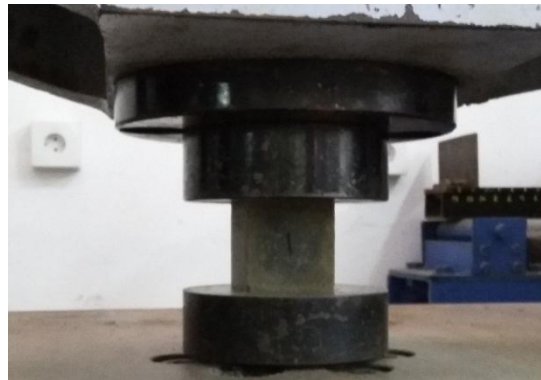
Gambar 4 - 10 Pengujian kuat tekan Sikagrout 215M umur 30 hari
