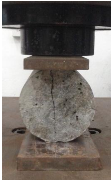
Gambar 4 - 16 Pengujian kuat tarik belah beton OPC
