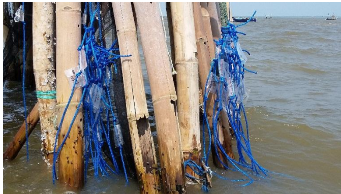
Gambar 3 - 23 Benda uji diikatkan pada tiap sisi bagan
