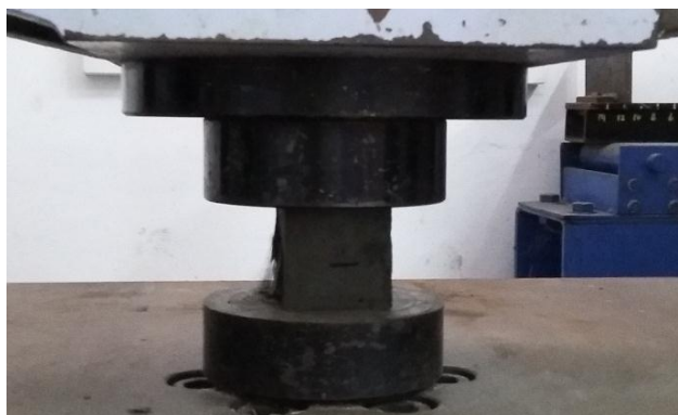
Gambar 4 - 9 Pengujian kuat tekan mortar geopolimer umur 30 hari
