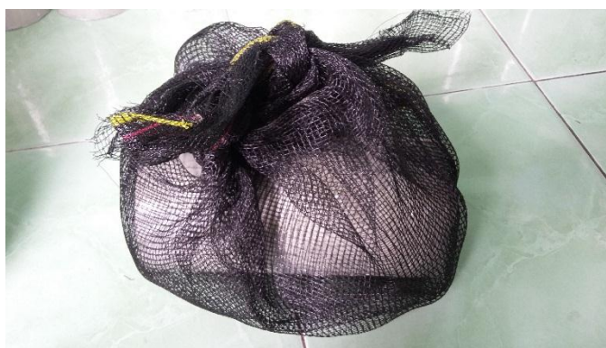
Gambar 3 - 20 Benda uji dibungkus dengan waring
