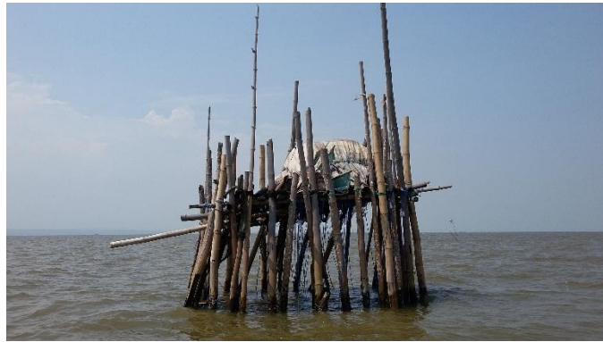
Gambar 3 - 22 Bagan (tempat meletakkan benda uji)
