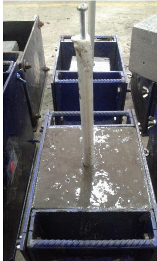
Gambar 3 - 19 Proses pencetakan mortar geopolimer pada beton OPC
