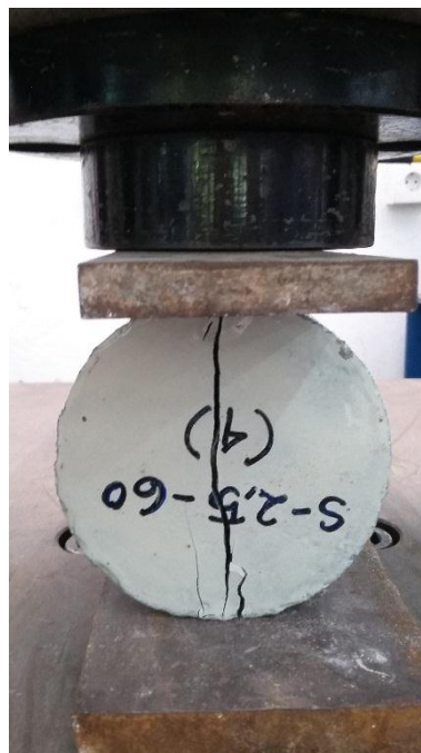
Gambar 4 - 17 Pengujian kuat tarik belah spesimen silinder dengan seawater curing
