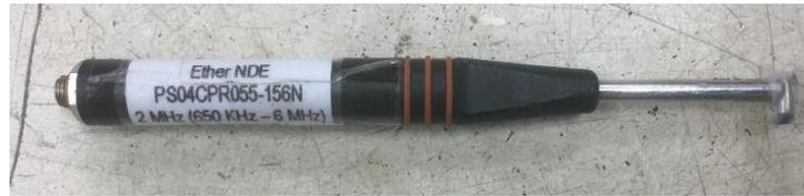
Gambar 3.9 Probe dengan Frekuensi 650 kHz
