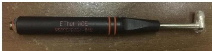
Gambar 3.8 *Probe* dengan Frekuensi 500 kHz
