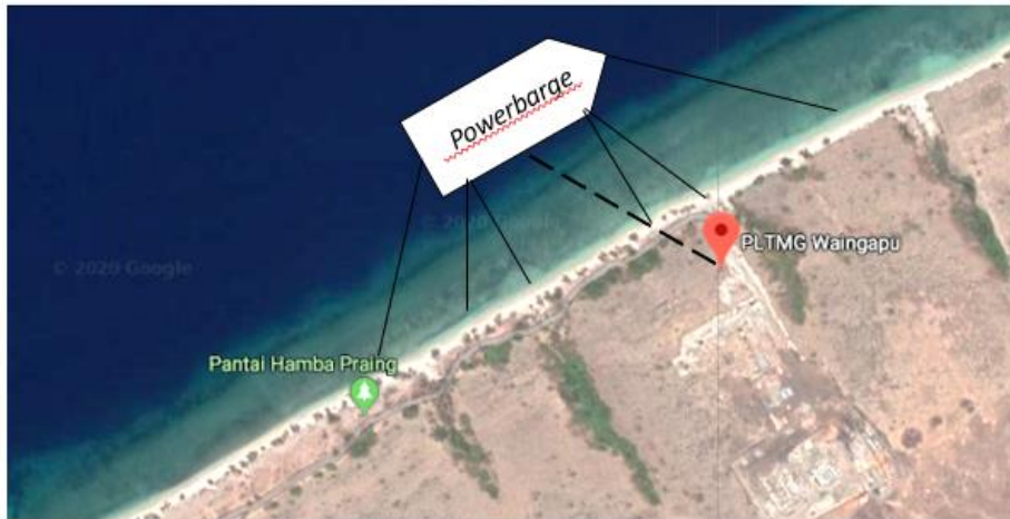
Gambar 5. 15. Rencana tambat powerbarge ketika beroperasi pada fase 1 di wilayah Sumba
