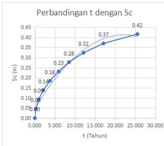
Gambar 7.3 Perbandingan t dan Sc STA 151+450
