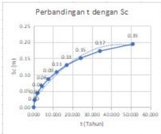
Gambar 7.1 Perbandingan t dan Sc STA 149+200
