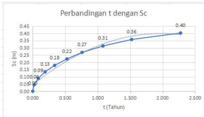
Gambar 7.2 Perbandingan t dan Sc STA 150+650
