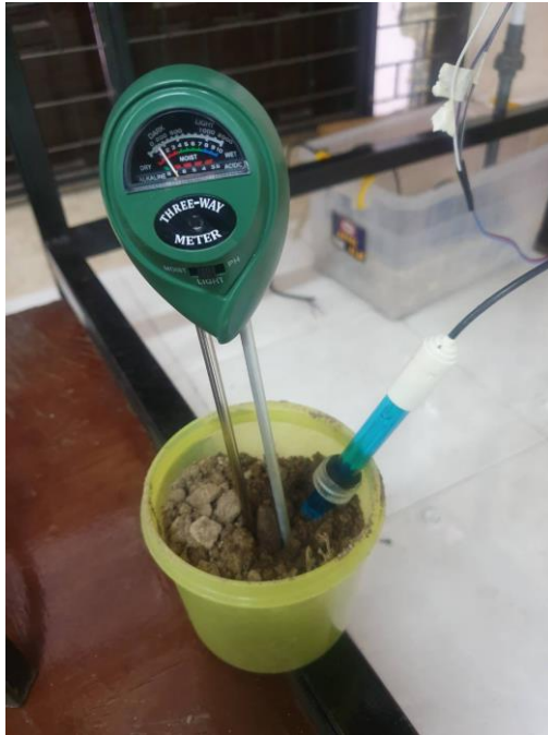
Gambar 4.2 kalibrasi sensor pH tanah
