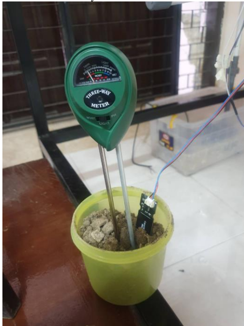
Gambar 4.1 kalibrasi sensor Kelembaban tanah
