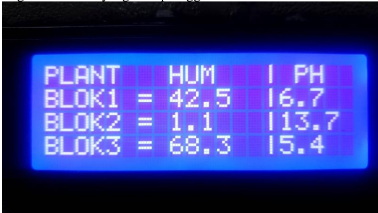
Gambar 4.7 Tampilan data monitoring kelembaban dan pH tanah pada LCD
