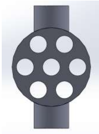
Gambar 3. 4 Geometri heat exchanger untuk validasi tampak depan
