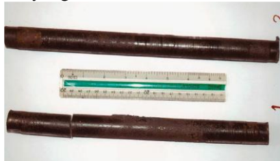
Gambar 2. 14 Dua Pin Penghubung
