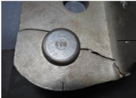
Gambar 4. 20 Mounting angle yang didekat kepala Pin mengalami Patah menjadi dua bagian
