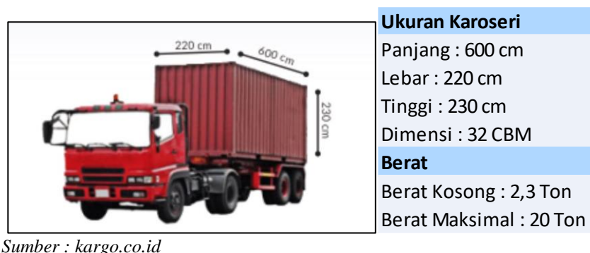
Gambar 5. 15 Spesifikasi Truk Trailer 20 feet
