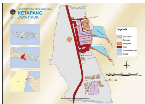
Sumber : Kementerian Perhubungan Ketapang Gambar 4. 25 Layout Pelabuhan Ketapang
