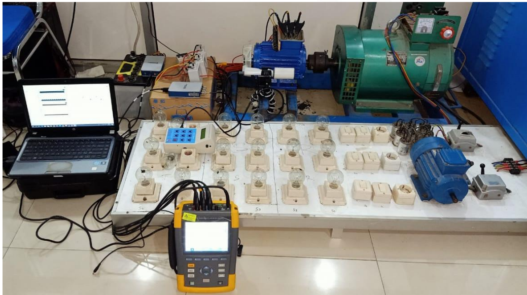
Gambar 3.14 Implementasi sistem deteksi gangguan hubung singkat belitan stator
