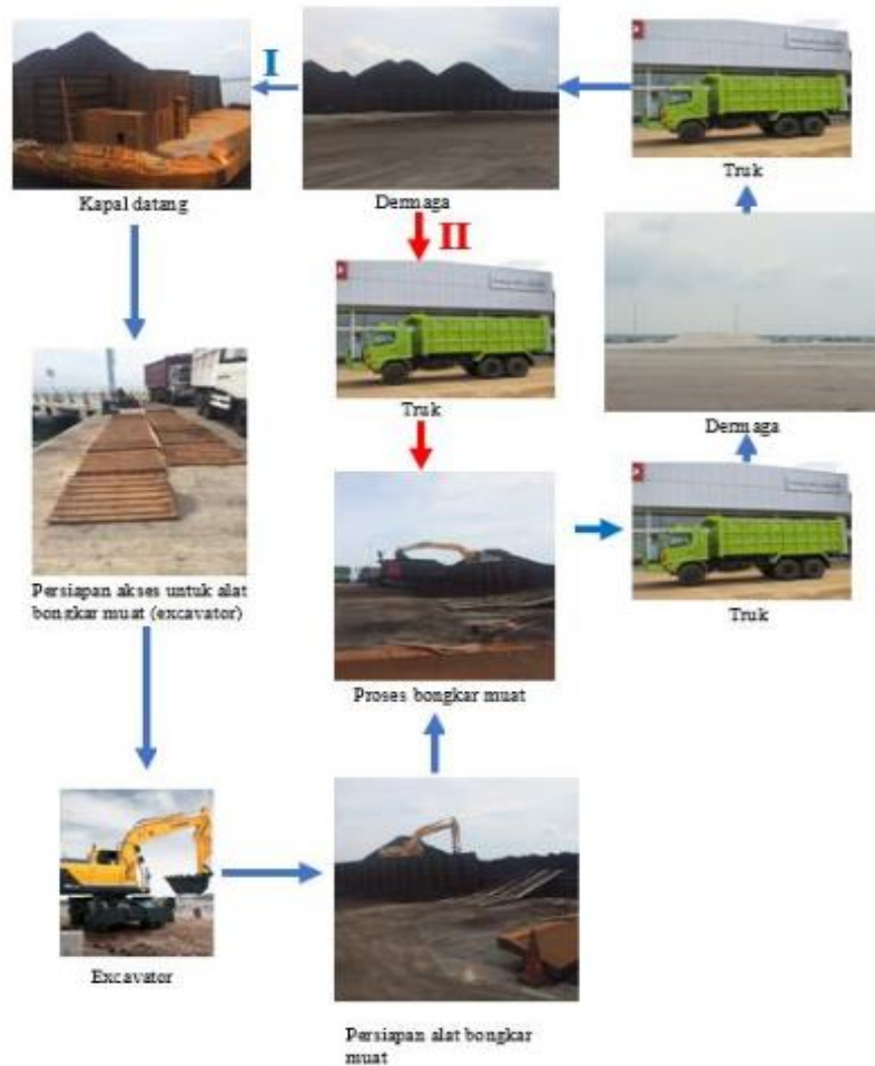
Gambar 4-13 Proses penanganan muatan menggunakan excavator
