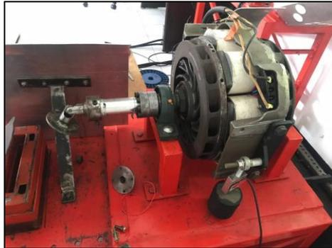
Gambar 3.4 Dinamometer dengan tipe eddy current brake
