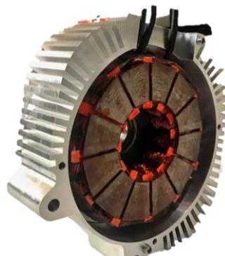
Gambar 4.11 Hasil jadi prototipe motor SRM bagian stator
