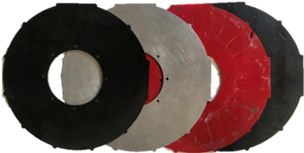
Gambar 4.13 Pemegang stator ki;ka (karbon fiber, alumunium, plastik, besi)
