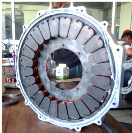
Gambar 4.12 Proses perakitan ke dalam cangkang motor
