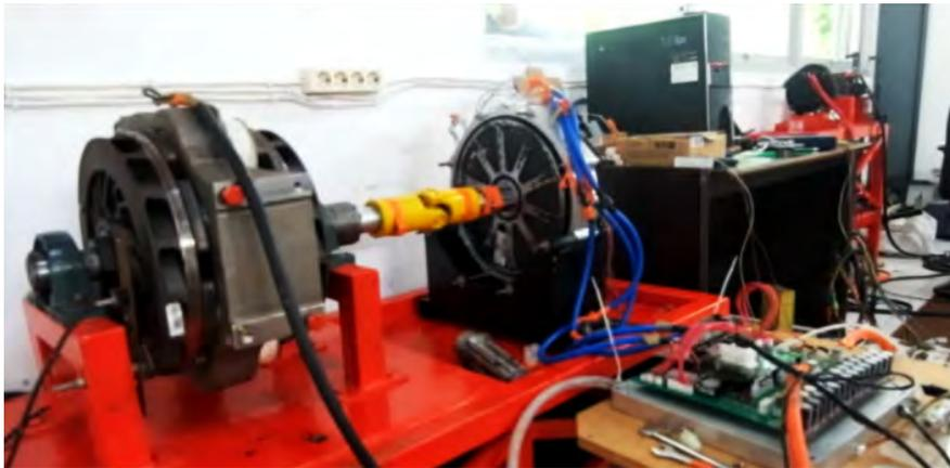
Gambar 4.14 Pengujian menggunakan dinamometer
