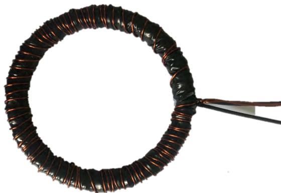
Gambar 3.2 Bentuk material yang bisa di uji pada alat uji histerisis
