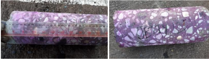
Gambar 4.21 Hasil Tes Karbonasi pada sample Core Drill
