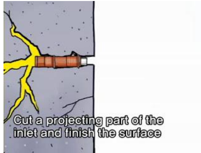
Gambar 8.11 Ilustrasi finishing akhir pelepasan nipple
