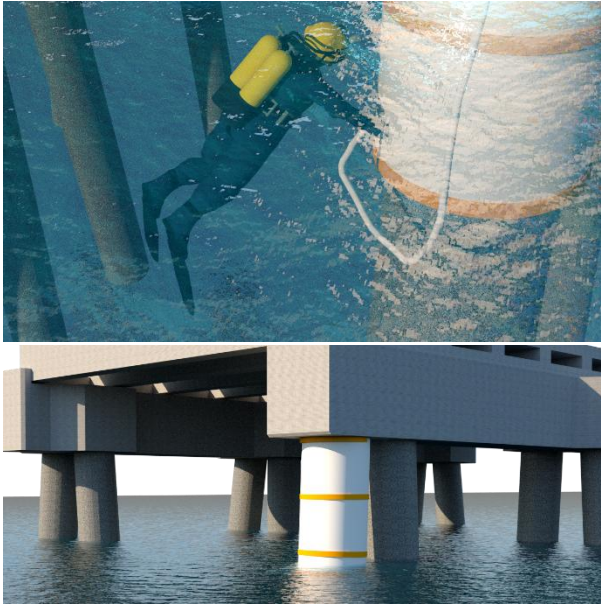
Gambar 8.48 Ilustrasi injeksi epoxy grout hingga topping off
