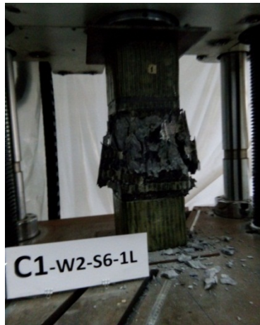
Spesimen C1-W2-S6-1L Setelah mengalami keruntuhan
