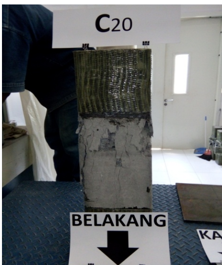
Gambar A25 Pengujian specimen kolom beton E-GFRP C20
