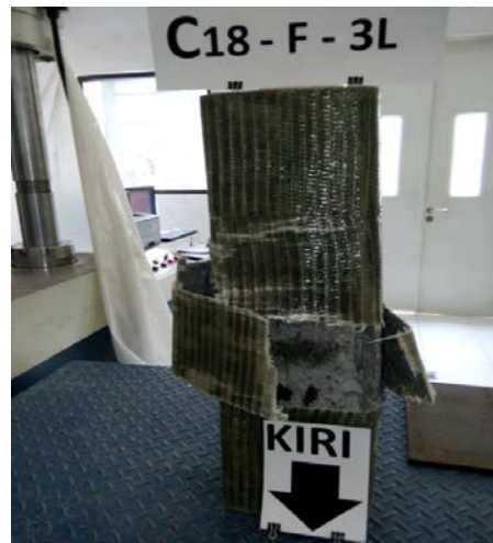
Gambar A23 Pengujian specimen kolom beton E-GFRP C18-F-3L
