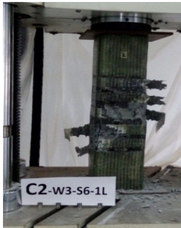
Spesimen C2-W3-S6-1L Setelah mengalami keruntuhan
