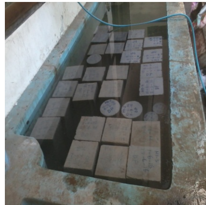
(d) Perawatan benda uji silinder
