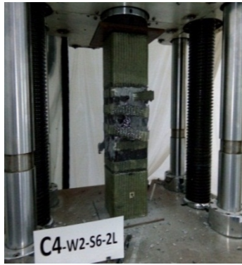
Spesimen C4-W2-S6-2L Setelah Mengalami Keruntuhan
