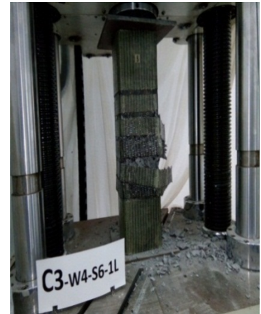
Spesimen C3-W4-S6-1L Setelah Mengalami Keruntuhan
