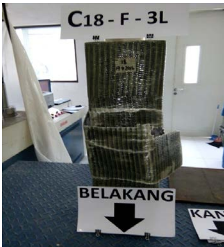
Gambar A23 Pengujian specimen kolom beton E-GFRP C18-F-3L
