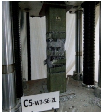
Spesimen C5-W3-S6-2L Setelah Mengalami Keruntuhan
