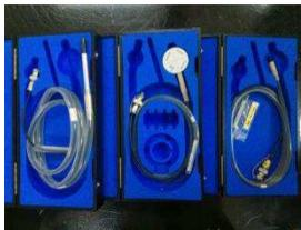
**Gambar 3.10** Detektor Plane Parallel Chamber PPC40 (MRCCC Siloam Hospital Semanggi, Jakarta Selatan)
