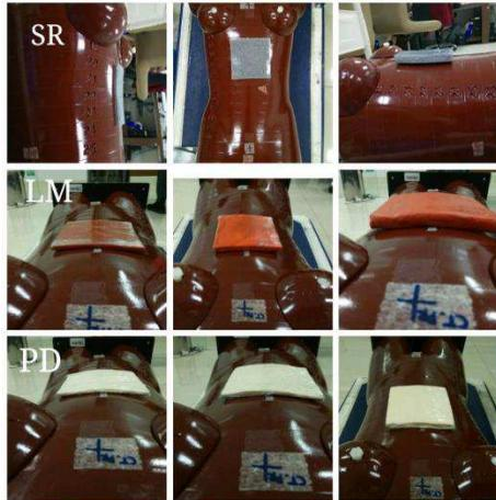
**Gambar 4.3** Bolus SR, LM dan PD pada Rando Phantom
