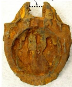
Gambar 2. 11 Karat pada katup dalam sistem perpipaan (Tait, 2018)
