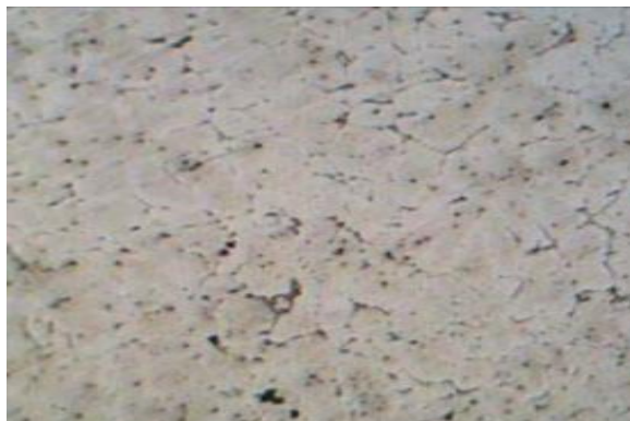
Gambar 2.48 Struktur mikro paduan aluminium dengan penambahan 0.1% timah perbesaran 100x (Umoru, L, 2007)
