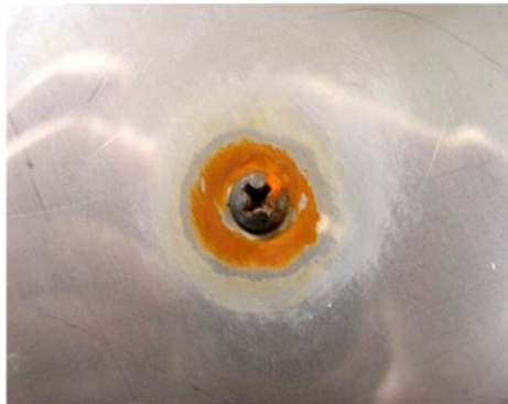
Gambar 2.12 Rivet tembaga yang dipasang pada plat baja (Tait,2018)
