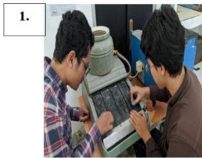
1. Grinding hingga grade 5000
