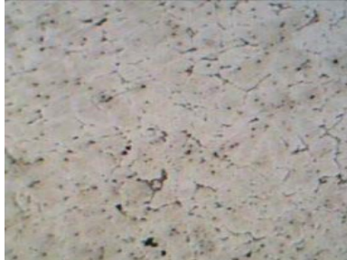
Gambar 2.34 Struktur mikro setelah adanya distribusi presipitat timah dengan penambahan 0.1 Sn (Umoru, 2007)
