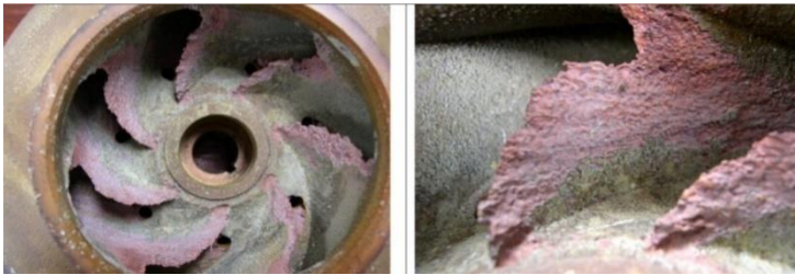
Gambar 2.17 Korosi erosi pada impeller pompa (Tait, 2018)
