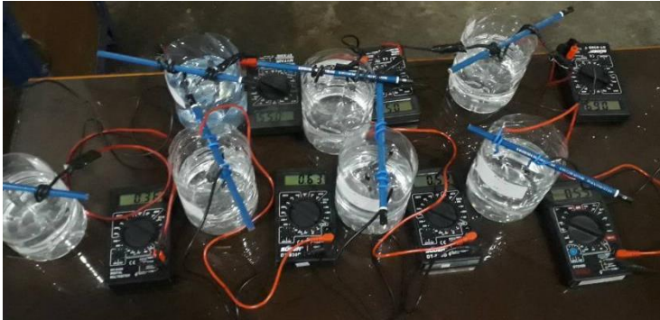
Gambar 3.9 Pengujian korosi galvanik
