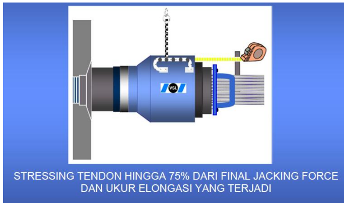
Gambar 4. 23 Stressing Tendon Hingga 75% Dari Final Jacking Force
