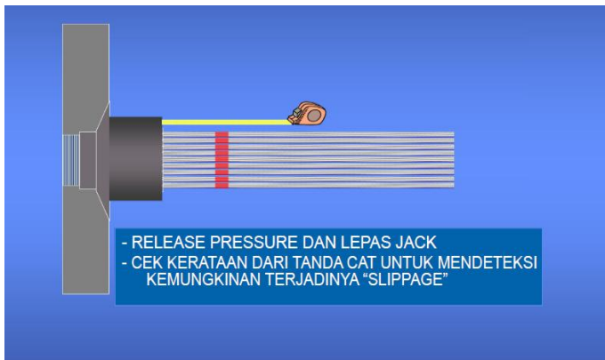
Gambar 4. 26 Release Presure dan Lepas Jack
