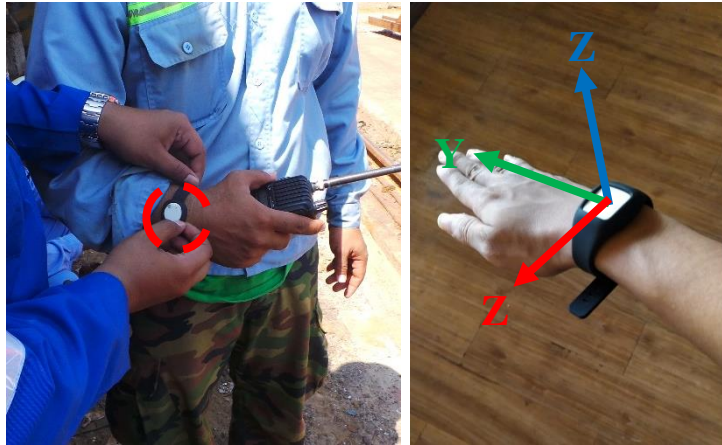
Gambar 5.1. Letak Posisi dan Arah Gerakan MetaMotion Sensor
