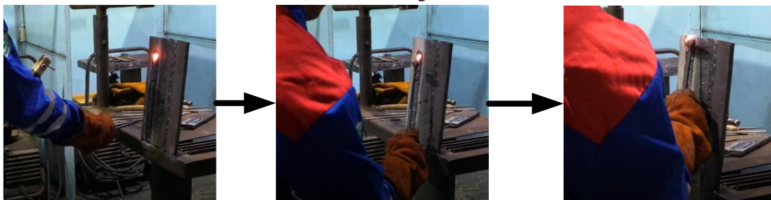
c) Gerakan Membersihkan Slag 3G Gambar 5.12. Proses Pengelasan 3G
