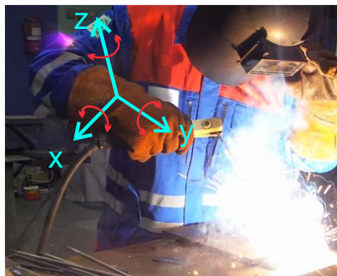
Gambar 2.7. Tipikal gerakan pengelasan manual
