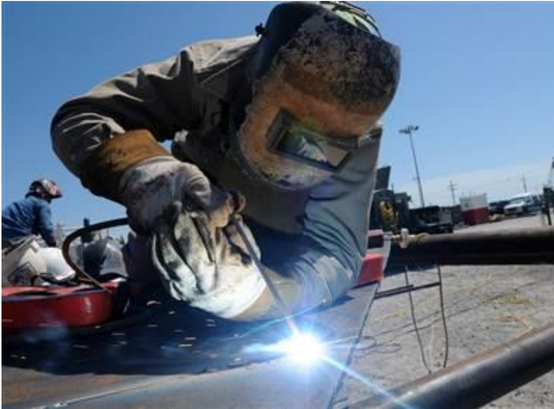
Gambar 4.9. Pengelasan SMAW di Building Berth pada Proses Assembly
