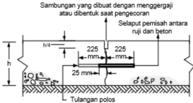
Gambar 2. 28 Sambungan susut melintang dengan ruji
