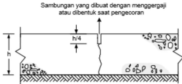
Gambar 2. 29 Sambungan susut melintang tanpa ruji
