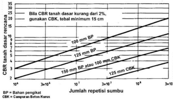
Gambar 2. 18 Tebal Pondasi Bawah Minimum Untuk Perkerasan Beton Semen
