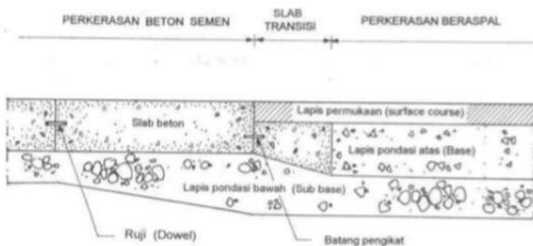
Gambar 2. 32 Slab transisi antara perkerasan beraspal
