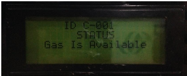
Gambar 4. 18 LCD 20x4 ketika tekanan >1 Bar
