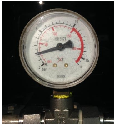
Gambar 4. 17 Pressure Gauge menunjukkan 2 Bar
