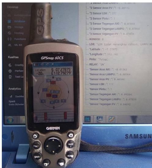
Gambar 4. 3 Pengujian Sensor GPS dengan GPSmap 60CS
