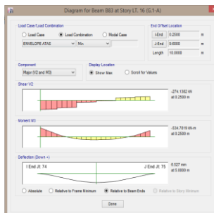
Gambar 1. Kondisi Eksisting M max = 534,78 KN-m
