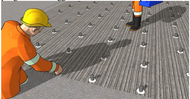
Gambar 9.14. Masukkan tulangan untuk chemical anchor
