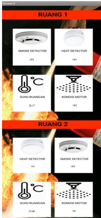
Gambar 4.7 Interface aplikasi Heat Detector Ruang 2
