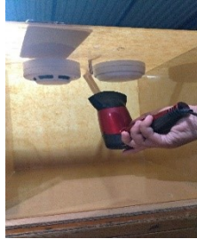
Gambar 4.11 Pengujian Heat Detector dengan DS18B20
