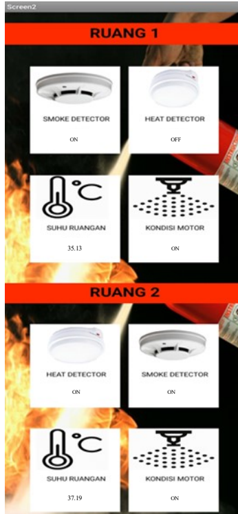
Gambar 4.23 Interface aplikasi Ketika kondisi Smoke Detector Ruang 1 Serta Smoke Detector Dan Heat Detector Ruang 2 Mendeteksi
