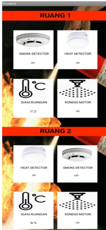
Gambar 4.22 Interface aplikasi Ketika kondisi Smoke Detector Dan Heat Detector Ruang 1 Serta Heat Detector Ruang 2 Mendeteksi
