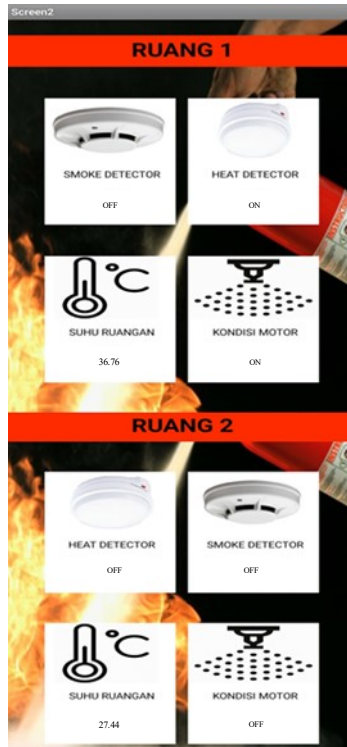
Gambar 4.15 Interface aplikasi Ketika kondisi Heat Detector Ruang 1 Mendeteksi
