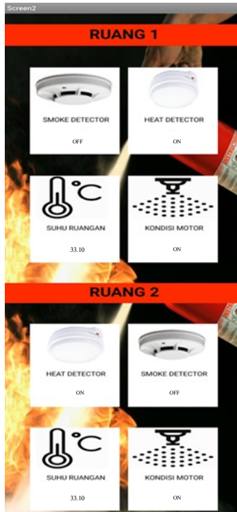
Gambar 4.8 Interface aplikasi Heat Detector Ruang 1 dan Ruang 2
