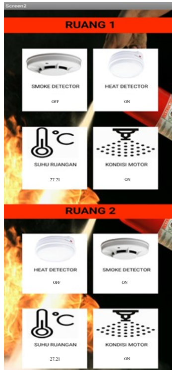
Gambar 4.25 Interface aplikasi Ketika kondisi Heat Detector Ruang 1 Serta Smoke Detector Ruang 2 Mendeteksi
