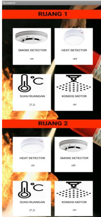
Gambar 4.26 Interface aplikasi Ketika kondisi Smoke Detector Ruang 1 Serta Heat Detector Ruang 2 Mendeteksi
