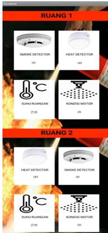
Gambar 4.4 Interface aplikasi Smoke Detector Ruang 1 dan Ruang 2
