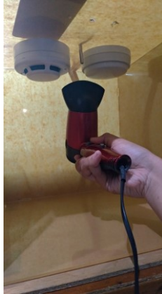
Gambar 4.9 Pengujian Sensor Suhu DS18B20
