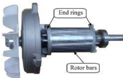
Gambar 2. 4 Ilustrasi Rotor Motor Induksi [7]
