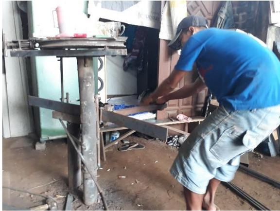
**Gambar. Proses Penekukan Pada Plat**
