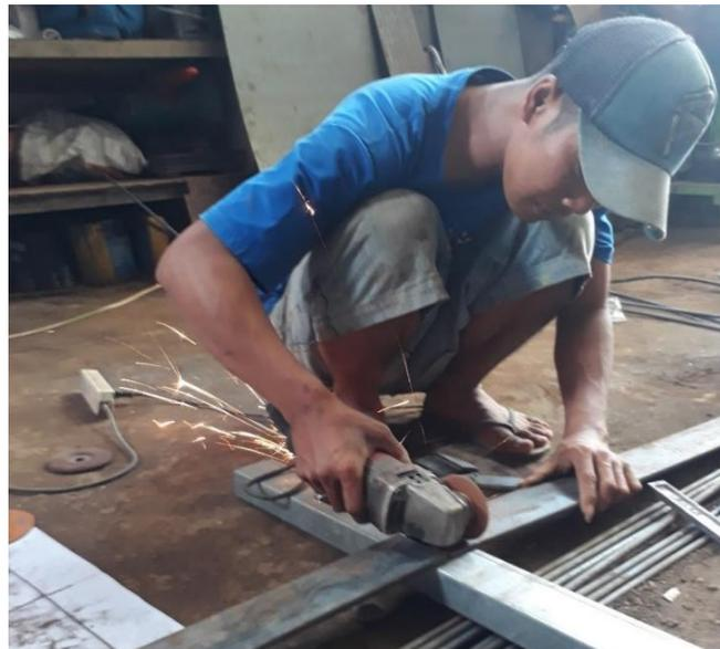
Gambar 4.4 Pemotongan Pelat
