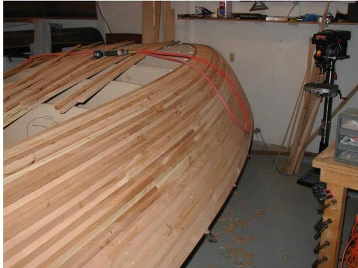
Gambar 2.6 Penempelan Kulit Ketode *Strip Planking*
