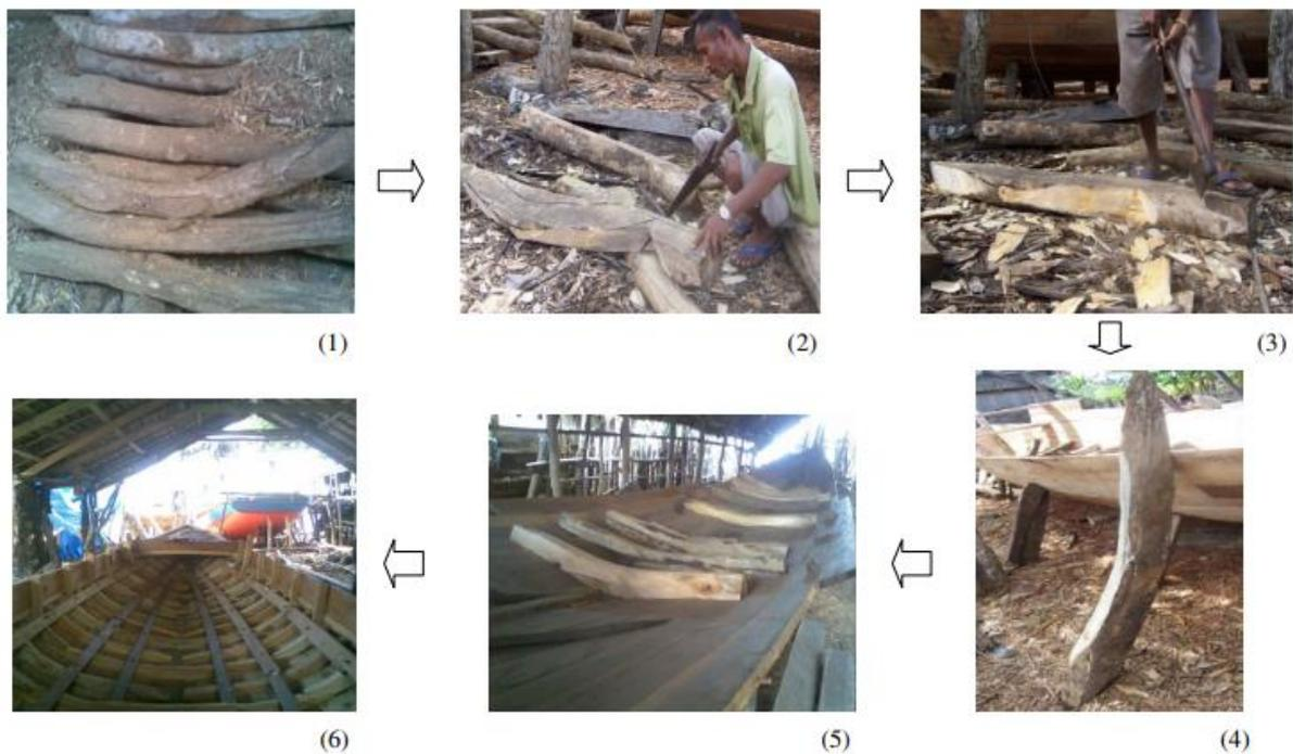
Gambar 2.12 Proses Pembuatan Gading Kayu
