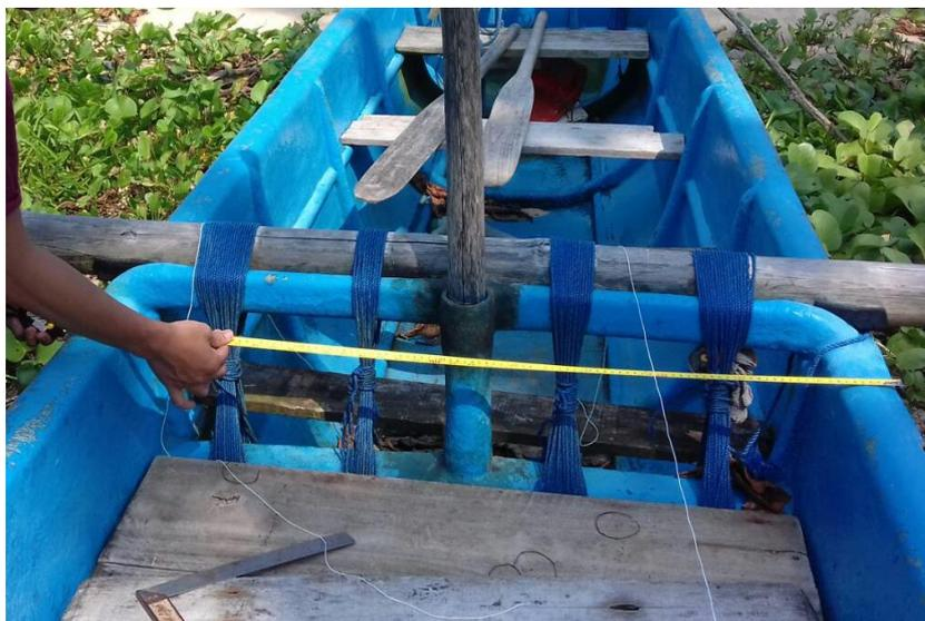
Gambar 3.2 Proses pengukuran kapal
