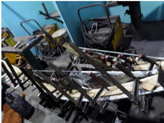
Gambar 2. 25 Proses laminasi dengan menggunakan alat pencetak gading
