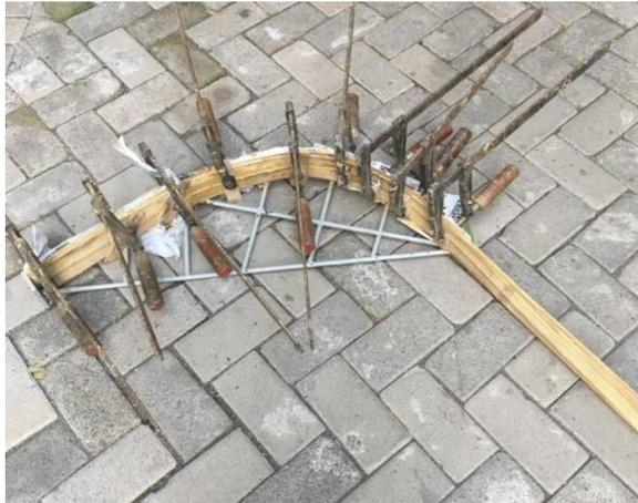
Gambar 4.13 Proses Pengempaan Menggunakan Klem F
