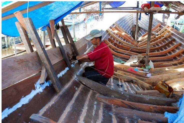
Gambar 2.15 Proses pembuatan lambung kapal tradisional
