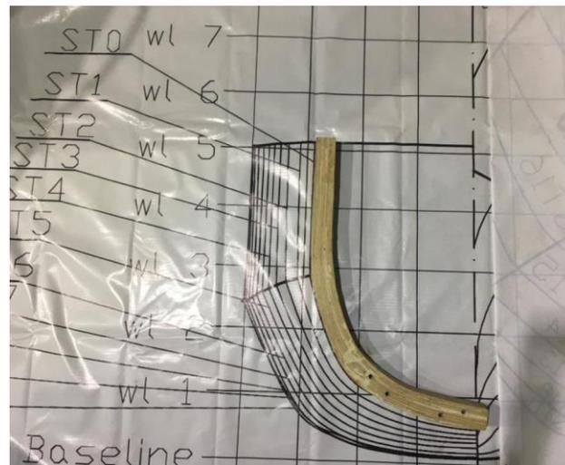
Gambar 4. 11 Proses Pengecekan Bentuk Gading
