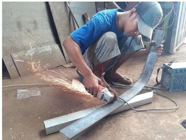
**Gambar. Penggrindaan Pada Bagian Yang Ektrim**
