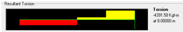
Gambar 4. 41 Output Torsi Sloof S1A Kombinasi : 0,9D+1EX+0,3EY Momen Torsi : -4391,58 kg-m
