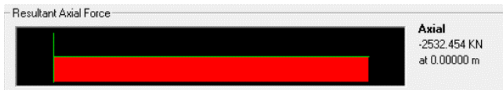
Gambar 4. 25 Output Pu1 kombinasi 1,2 D + 1,6L + 0,5RL
