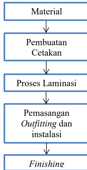
Gambar 5.1 Alur pembangunan kapal FRP
