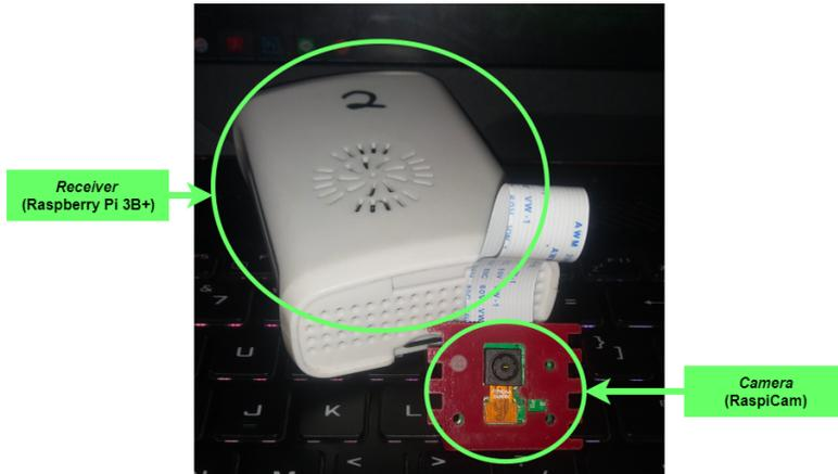
**Gambar 3.7:** Perangkat Receiver dan Raspicam
