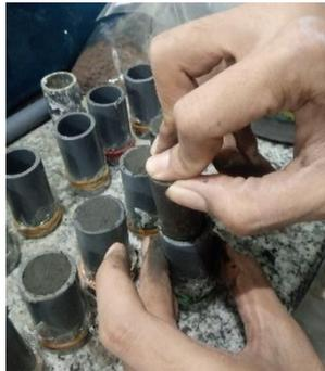
Gambar 4.8 Proses pencetakan pasta geopolimer dalam cetakan silinder.
