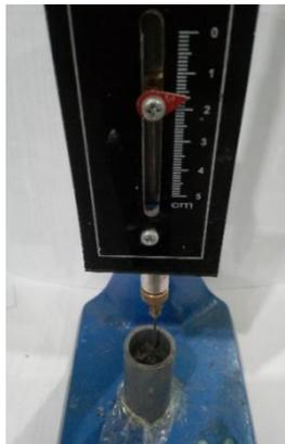
Gambar 2.9 Pengujian *setting time* menggunakan instrumen Vicat Apparatus pada geopolimer
