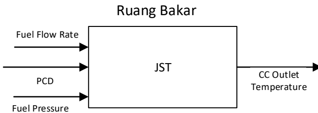
Gambar 3.7 Diagram blok ruang bakar
