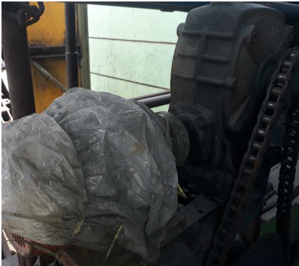
Gambar 3.5 Motor Pengerak dan Gearbox Di PG Tjoekir
