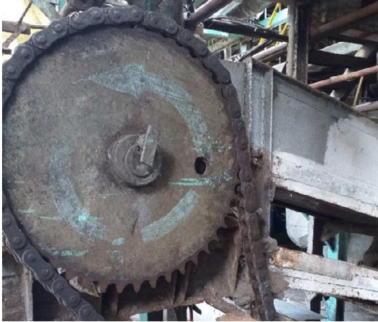
Gambar 3.6 Rantai dan Sproket Transmisi Di PG Tjoekir
