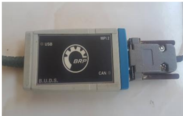
Gambar 0.2 Unit BUDS yang memungkinkan untuk membaca ECU Sea Doo
