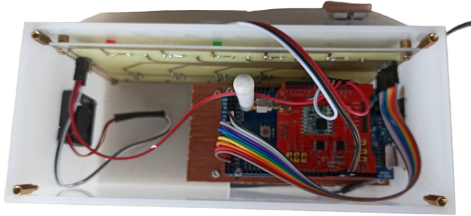
Gambar 4.4: Tampilan Dalam Packaging Perangkat End Node
