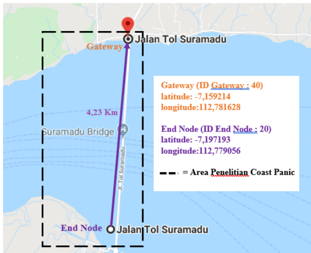
Gambar 4.5: Area lokasi pengiriman data dari End Node ke Gateway secara langsung
