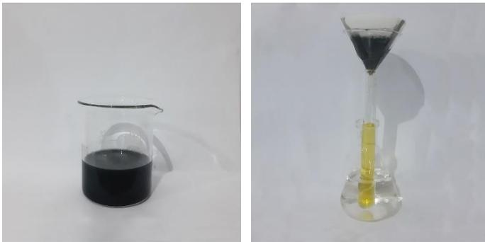
**Gambar 4.7** Proses (a) *Bleaching* dan (b) Penyaringan
