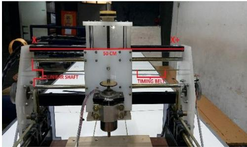
Gambar 3.1 Bentuk Mekanik CNC Portable x Axis
