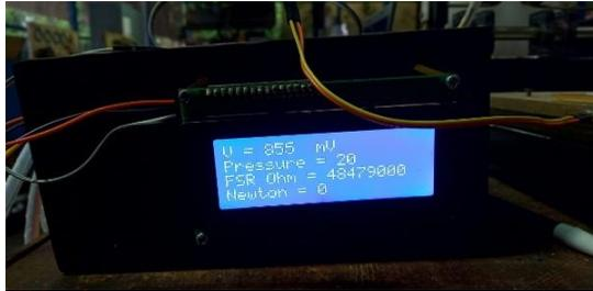
**Gambar 4.30** Tekanan Pada Papan PCB Berbahan *Fiber*.
