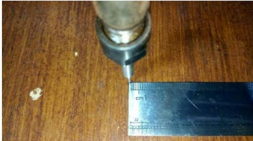
**Gambar 4.4** Hasil 1 mm Setelah Proses Kalibrasi
