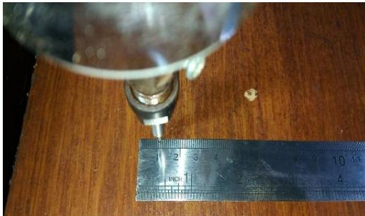
**Gambar 4.5** Hasil 10 mm Setelah Proses Kalibrasi
