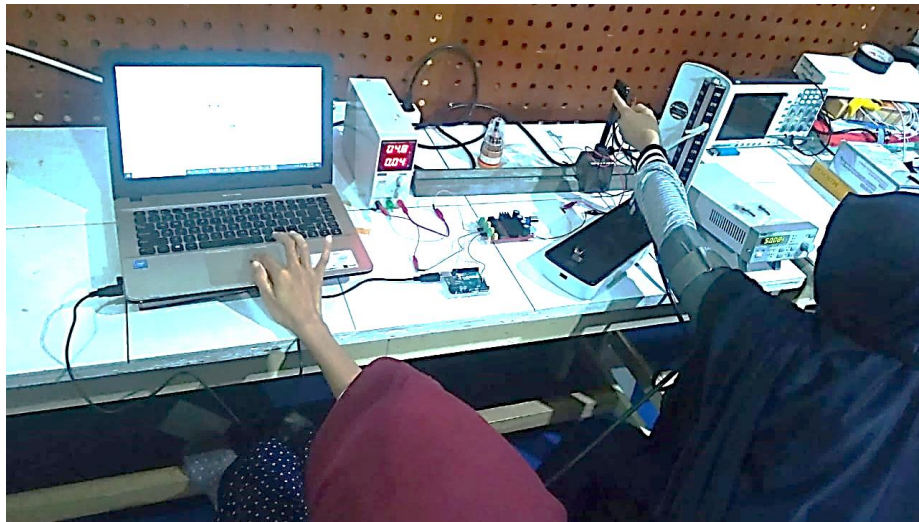
Gambar 3.7 Proses Pengambilan Data Pola Spekel Pada Pengukuran Jari Telunjuk
