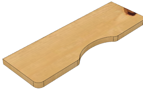
Gambar 6. 1 Lekukan pada Tepi Panel
