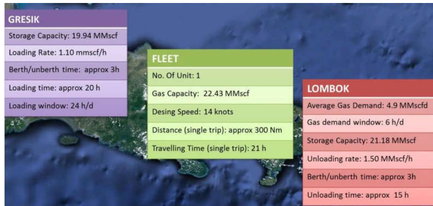
Gambar IV.10 Data fasilitas Loading – Unloading pelabuhan Gresik – Lombok
