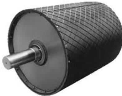
**Gambar 2.12 *Pulley dengan Pelapis Karet***
