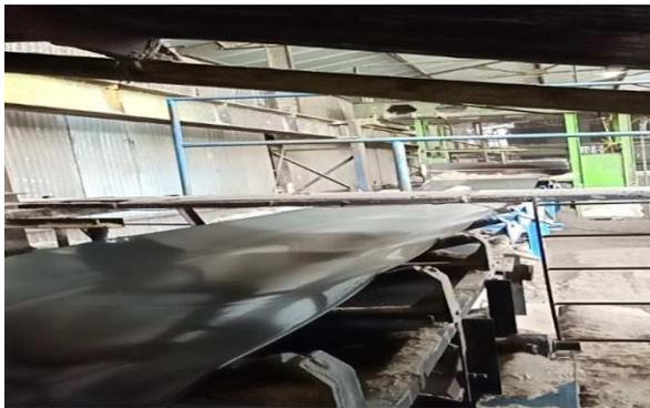
**Gambar 3.4 *Belt Conveyor* Pengangkut Abu Ampas Tebu**
