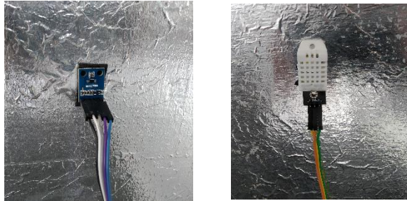
Gambar 4.5: Pemasangan sensor DHT22 dan BH1750.
