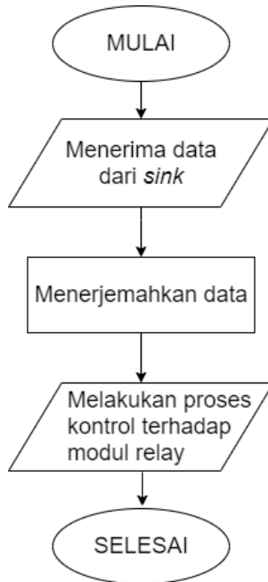
Gambar 3.7: Alur penerimaan data pada source node .
