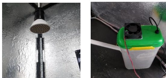
Gambar 4.4: Pemasangan growlamp dan mist maker.
