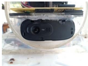
Gambar 3.4 Penempatan Kamera Pada Tabung ROV
