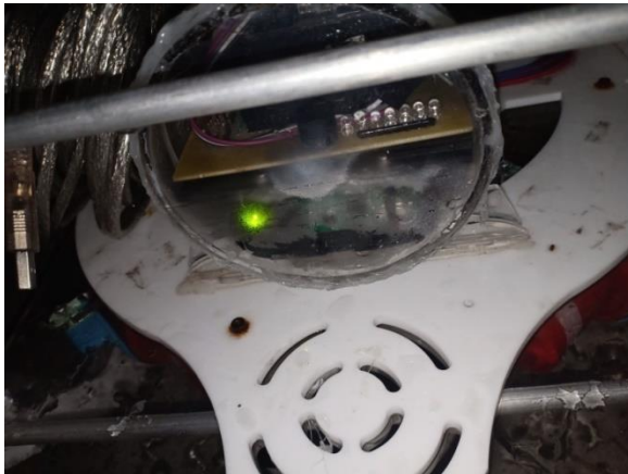
Gambar 4.17 Mengembunnya Akrilik Pada Tabung ROV
