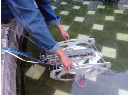
Gambar 4.4 Pengujian Kebocoran Tabung Dalam Air
