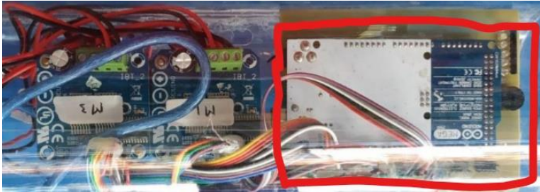
Gambar 3.18 Posisi Yang Akan Ditempati Arduino Uno
