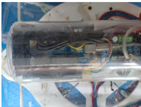
Gambar 4.2 Letak Webcam & Kompas Pada Tabung
