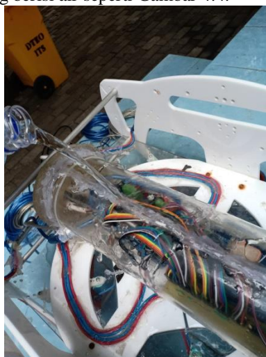
Gambar 4.3 Pengujian Kebocoran Penyiraman Air Pada Tabung ROV
