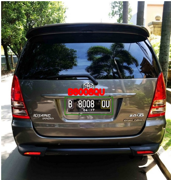
Gambar 4.12: Deteksi dan Identifikasi Nomor Registrasi Plat Bagian Belakang Menggunakan Input Foto Tanpa Kesalahan.
