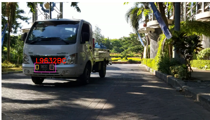
Gambar 4.14: Deteksi dan Identifikasi Nomor Registrasi Plat Bagian Depan Menggunakan Input Video Tanpa Kesalahan.
