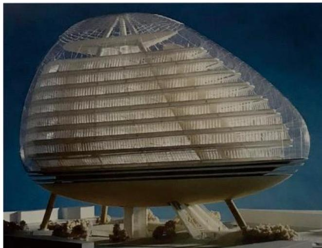
Gambar 2.42 Bentuk telur dan kaki tripod untuk merespon aliran angin di selubung dan atrium pada bangunan proyek penelitian bangunan hijau 1990 (Compagno, 1995)
