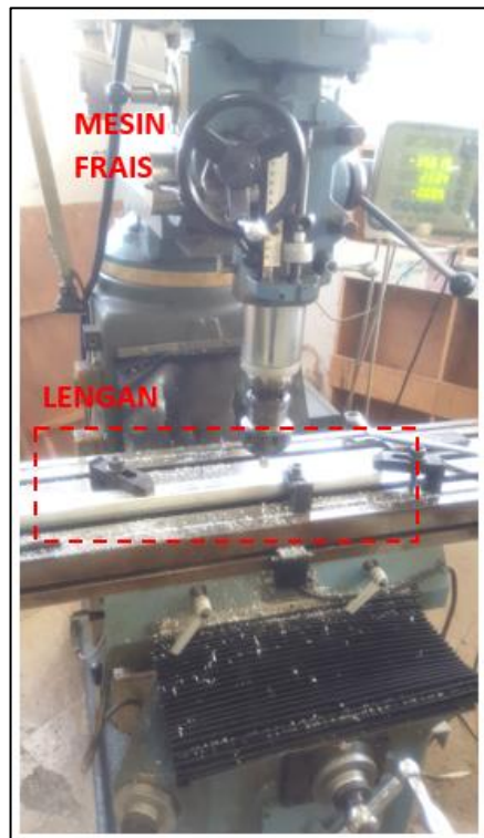
Gambar 3.5 Proses permesinan komponen lengan pada fabrikasi komponen mekanik.
