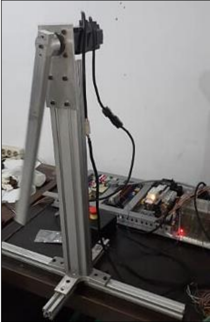
Gambar 3.2 Set eksperimen joint impedance control berbasis torsi dengan kompensasi friksi dan gravitasi.
