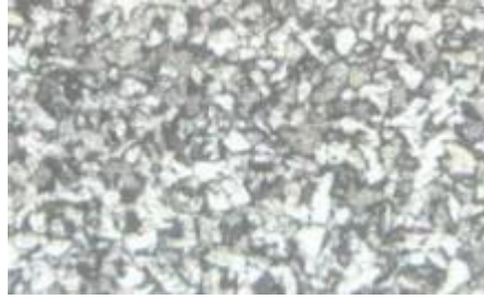
Gambar 4.46 Hasil Foto Mikro Spesimen SMAW daerah HAZ
