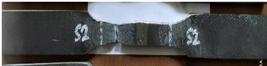
Gambar 4.26 Hasil Uji Tarik pada Spesimen Hasil Pengelasan SMAW Nomor 2
