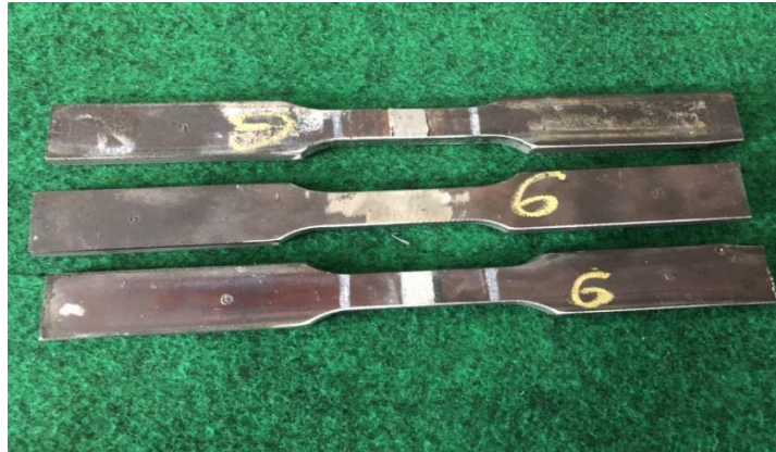
Gambar 3.11 Spesimen Hasil Pengelasan GTAW Untuk Uji Tarik (sumber: Dokumen Pribadi)
