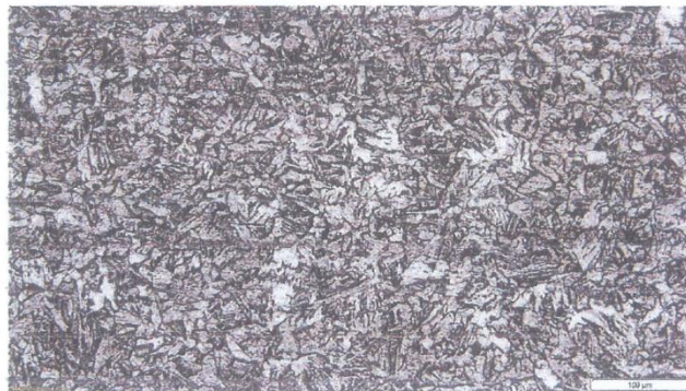
Gambar 2. Struktur mikro benda uji Butt joint FCAW di daerah terpengaruh panas (Heat Affected Zone)
