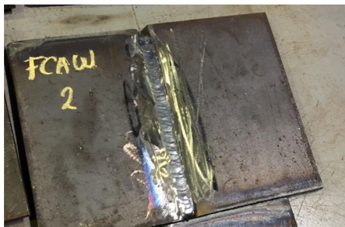
Gambar 4.9 Hasil Pengelasan FCAW Spesimen No 2 (sumber: Dokumen Pribadi)
