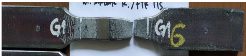
Gambar 4.19 Hasil Uji Tarik pada Spesimen Hasil Pengelasan GTAW Nomor 1
