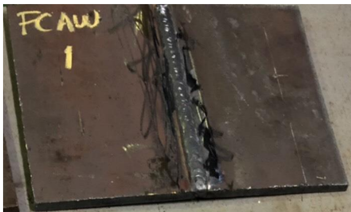
Gambar 4.7 Hasil Pengelasan FCAW Spesimen No 1 (sumber: Dokumen Pribadi)
