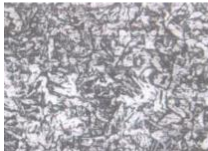
Gambar 4.43 Hasil Foto Mikro Spesimen FCAW Daerah HAZ
