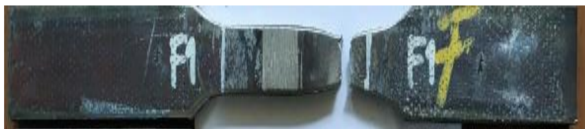
Gambar 4.22 Hasil Uji Tarik pada Spesimen Hasil Pengelasan FCAW Nomor 1
