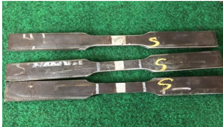
Gambar 3.12 Spesimen Hasil Pengelasan SMAW Untuk Uji Tarik (sumber: Dokumen Pribadi)
