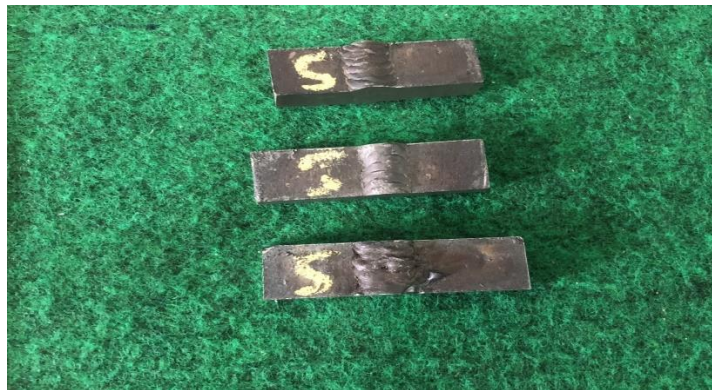
Gambar 3.15 Spesimen Hasil Pengelasan SMAW Untuk Uji Kekerasan dan Struktur Mikro (sumber: Dokumen Pribadi)
