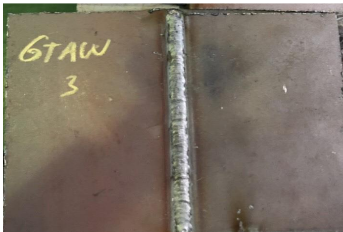
Gambar 4.5 Hasil Pengelasan GTAW Spesimen No 3 (sumber: Dokumen Pribadi)
