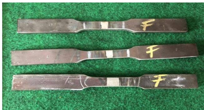
Gambar 3.10 Spesimen Hasil Pengelasan FCAW Untuk Uji Tarik (sumber: Dokumen Pribadi)
