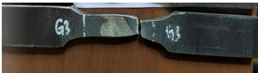
Gambar 4.21 Hasil Uji Tarik pada Spesimen Hasil Pengelasan GTAW Nomor 3
