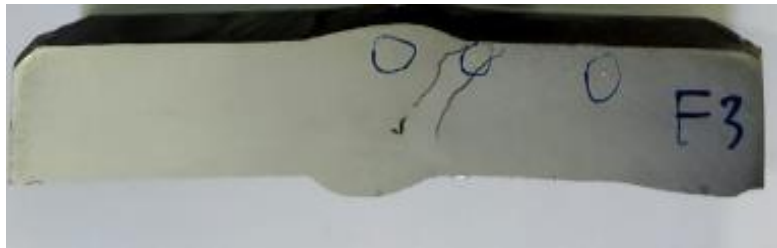
Gambar 4.34 Titik Pengujian Kekerasan pada Spesimen Hasil Pengelasan FCAW Nomor 3
