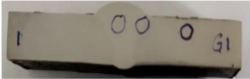
Gambar 4.29 Titik Pengujian Kekerasan pada Spesimen Hasil Pengelasan GTAW Nomor 1
