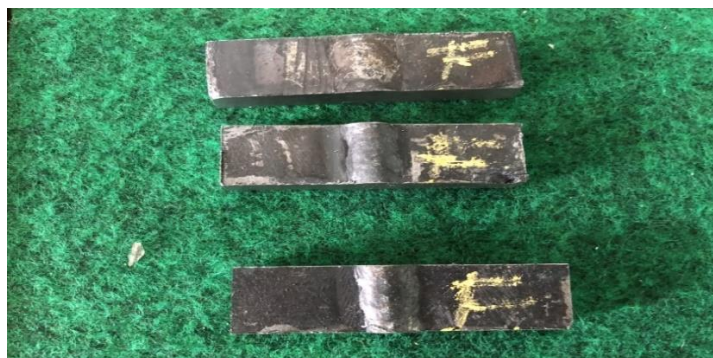
Gambar 3.13 Spesimen Hasil Pengelasan FCAW Untuk Uji Kekerasan dan Struktur Mikro (sumber: Dokumen Pribadi)
