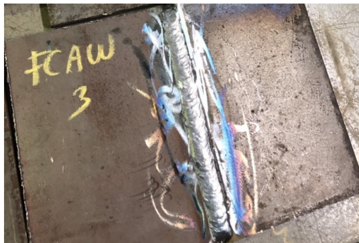
Gambar 4.11 Hasil Pengelasan FCAW Spesimen No 3 (sumber: Dokumen Pribadi)
