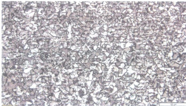
Gambar 2. Struktur mikro benda uji Butt joint SMAW di daerah terpengaruh panas (Heat Affected Zone)
