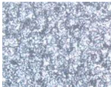
Gambar 4.41 Hasil Foto Mikro Spesimen GTAW daerah Weld Metal
