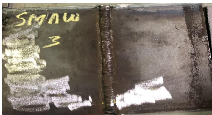
Gambar 4.17 Hasil Pengelasan SMAW specimen No 3 (sumber: Dokumen Pribadi)
