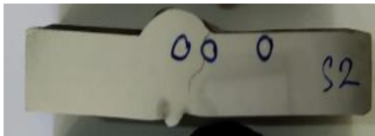
Gambar 4.36 Titik Pengujian Kekerasan pada Spesimen Hasil Pengelasan SMAW Nomor 2
