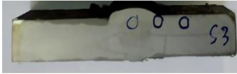
Gambar 4.37 Titik Pengujian Kekerasan pada Spesimen Hasil .Pengelasan SMAW Nomor 3
