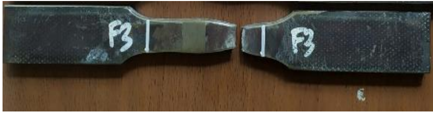
Gambar 4.24 Hasil Uji Tarik pada Spesimen Hasil Pengelasan FCAW Nomor 3
