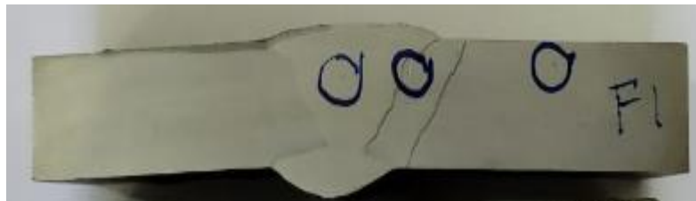
Gambar 4.32 Titik Pengujian Kekerasan pada Spesimen Hasil Pengelasan FCAW Nomor 1
