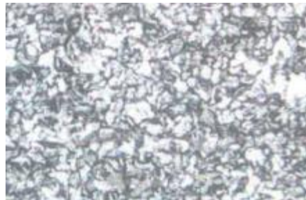
Gambar 4.39 Hasil Foto Mikro Spesimen GTAW daerah Base Metal
