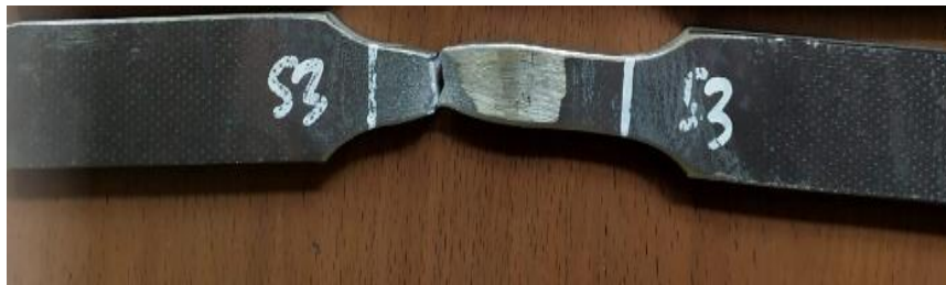
Gambar 4.27 Hasil Uji Tarik pada Spesimen Hasil Pengelasan SMAW Nomor 3 (sumber: Dokumen Pribadi)
