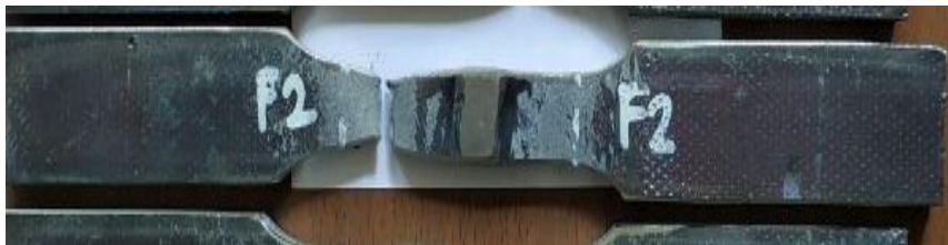
Gambar 4.23 Hasil Uji Tarik pada Spesimen Hasil Pengelasan FCAW Nomor 2
