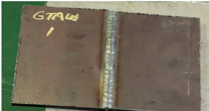
Gambar 4.1 Hasil Pengelasan GTAW Spesimen No 1 (sumber: Dokumen Pribadi)
