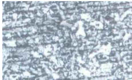
Gambar 4.40 Hasil Foto Mikro Spesimen GTAW daerah HAZ
