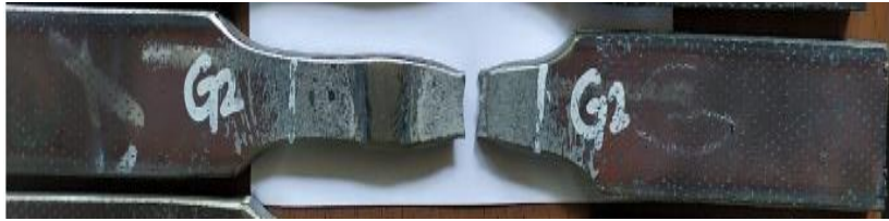
Gambar 4.20 Hasil Uji Tarik pada Spesimen Hasil Pengelasan GTAW Nomor 2
