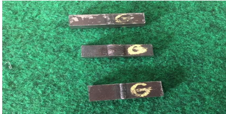
Gambar 3.14 Spesimen Hasil Pengelasan GTAW Untuk Uji Kekerasan dan Struktur Mikro (sumber: Dokumen Pribadi)
