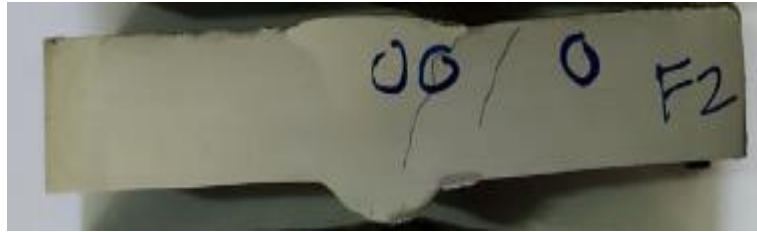
Gambar 4.33 Titik Pengujian Kekerasan pada Spesimen Hasil Pengelasan FCAW Nomor 2
